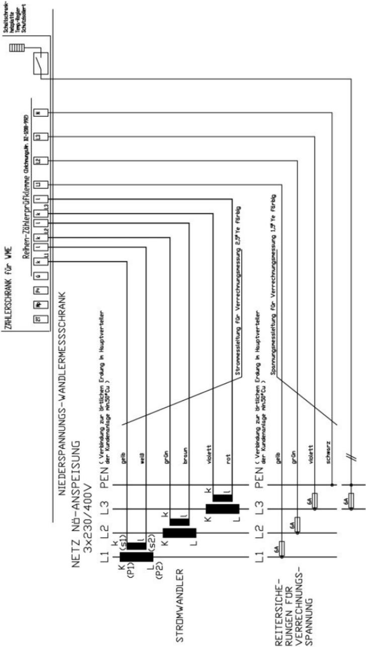
Abbildung 34: Wandermesseinrichtung für Verrechnungszwecke – Einschubplatten-
